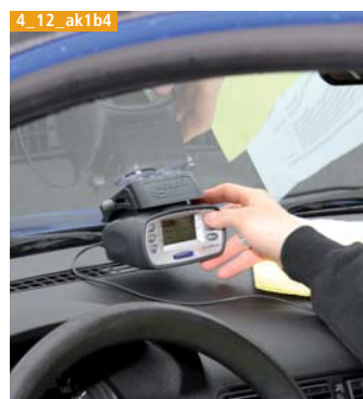
Bild 4. Mit der Driftbox, einem GPS-gestützten Gerät, können die Geschwindigkeit, die gefahrene Strecke, die Längs- und Querkräfte erfasst sowie gespeichert werden.
