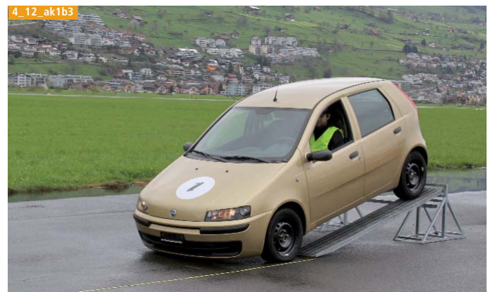
Bild 3. Für die Bestimmung des Rollwiderstandes wird die Strecke gemessen, welche das Fahrzeug beim Ausrollen von einer Rampe bis zum Stillstand zurücklegt.
