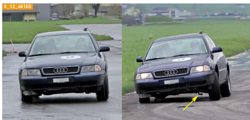
Bild 5. Unterschiedliche Wankneigung: li. mit Kurvenstabilisator; re. Kurvenstabilisator abgehängt (Pfeil).
