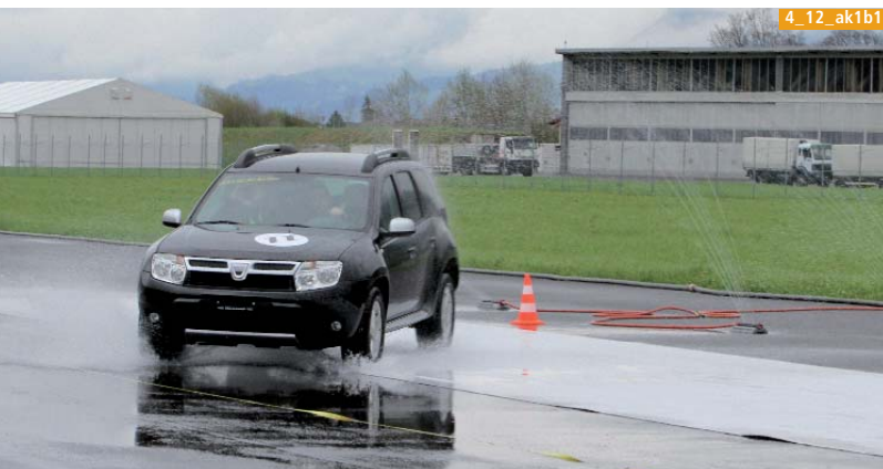
Bild 1. Der Bremsversuch mit ausgeschaltetem ABS auf \mu -Split (links/rechts unterschiedlich hoher Reibwert \mu ) zeigt auf, dass der Fahrer das Fahrzeug kaum mehr beherrschen kann.
