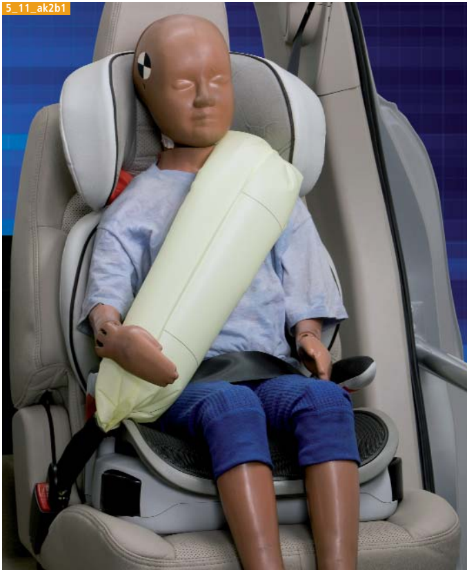
Bild 1. Der Gurtairbag erhöht den Tragekomfort und reduziert die Belastungsenergie auf den Körper durch die fünffache Auflagefläche gegenüber eines normalen Gurtbandes.
