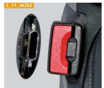
Bild 2. Gurtzunge und Gurtschloss sind speziell aufeinander abgestimmt, damit das Gas in den Gurtairbag strömen kann.
